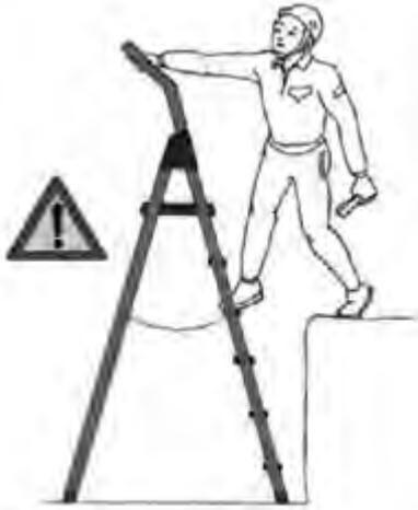
**Scala a gradini:** consente la salita per il superamento del dislivello e permette un breve posizionamento in altezza della persona, con un confort maggiore rispetto alla scala a pioli, in quanto il gradino ha una larghezza maggiore del piolo.
